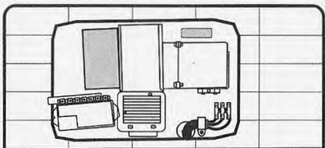
**5** CONNECT THE POWER CORD TO THE TERMINAL AND TIGHTEN THE SCREWS. IMPORTANT: DO NOT LIFT THE DRYER BY THE ELECTRICAL PARTS.
